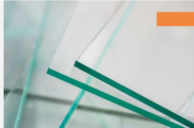
Das Basismaterial ist ein extra klares eisenoxidarmes Weißglas. Durch ein Vakuum-Magnetron-Sputterverfahren werden mehrere Nanometer dünne Schichten aus sorgfältig ausgewählten Metall- und Mineraloxiden auf die Oberfläche aufgebracht. Aufgrund der unterschiedlichen Brechungsindizes dieser Schichten werden Oberflächenreflexionen eliminiert. Das Ergebnis sind Restflächenreflexionen von weniger als 1%, die das Glas praktisch unsichtbar machen und eine klare, ungehinderte Sicht ermöglichen.
