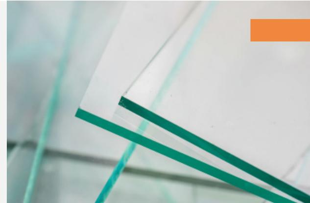
Das Basismaterial ist ein extra klares eisenoxidarmes Weißglas. Durch ein Vakuum-Magnetron-Sputterverfahren werden mehrere Nanometer dünne Schichten aus sorgfältig ausgewählten Metall- und Mineraloxiden auf die Oberfläche aufgebracht. Aufgrund der unterschiedlichen dieser Schichten werden Oberflächenreflexionen eliminiert. Das Ergebnis sind Restflächenreflexionen von weniger als 1%, die das Glas praktisch unsichtbar machen und eine klare, ungehinderte Sicht ermöglichen.
