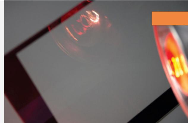
Im Freien platzierte Informationsdisplays sind starkem Nahinfrarotlicht (NIR) der Sonne ausgesetzt. Das nahe Infrarotlicht heizt das Display auf, was zu Fehlfunktionen führen und die Lebensdauer erheblich verringern kann.
